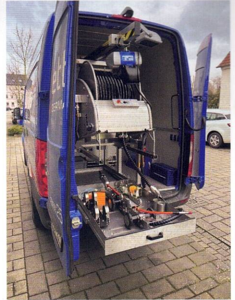
Das Baustellenfahrzeug des Bauunternehmens Jetting ist ausgerüstet mit einem Wasserhöchstdruckroboter
